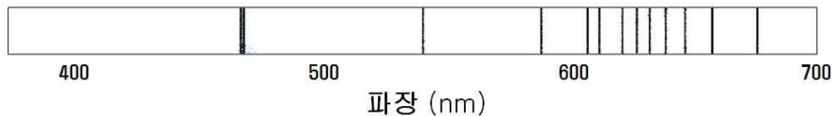
[그림 2] 네온 기체의 흡수 선 스펙트럼 ( 1\text{nm} = 1 \times 10^{-9}\text{m} )
